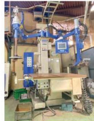
テーブルスポット溶接機は、金属部品を接合する抵抗溶接機の一種で、作業台(テーブル)の上でスポット溶接を行う装置です。2枚の金属板を電気と圧力で一点を加熱して接合するため、「スポット(点)」で溶接するのが特徴です。
